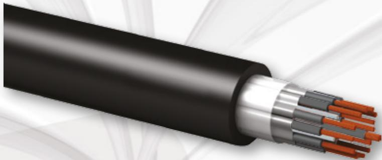
Se recomiendan los cables FICOM-F para la instalación en circuitos de control y protección, en la que desea reducir los costos de instalación. Estos cables pueden ser instalados de acuerdo con la NBR 5410 al aire libre en bandejas en los canales, enterrado directamente en el suelo en conductos o tuberías subterráneas.
