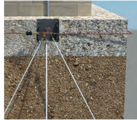
Fig. 13 - Sección transversal de una puesta a tierra.
