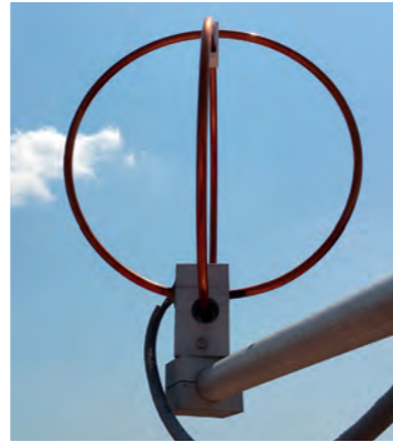
Fig. 24 - Sensor-Antena de campo LINET.
