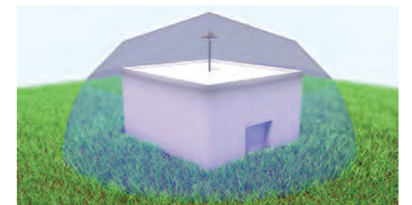
Fig. 4 – Volumen de protección de un PDC.
